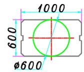
1. 工装板规格为双层旋转式, 下层600\*1000mm, 上层为 $\phi 600$ ,
